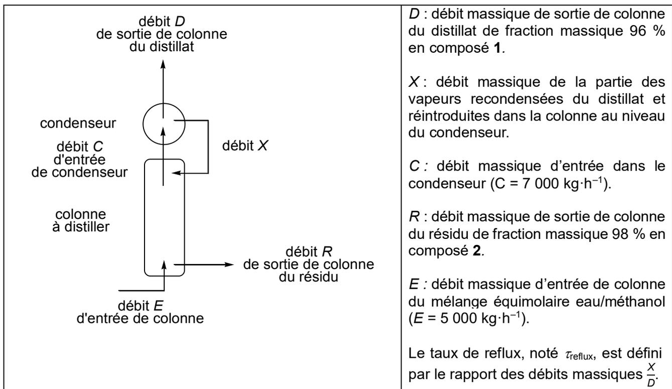
**Figure 4** - Schéma simplifié du procédé de rectification continue
