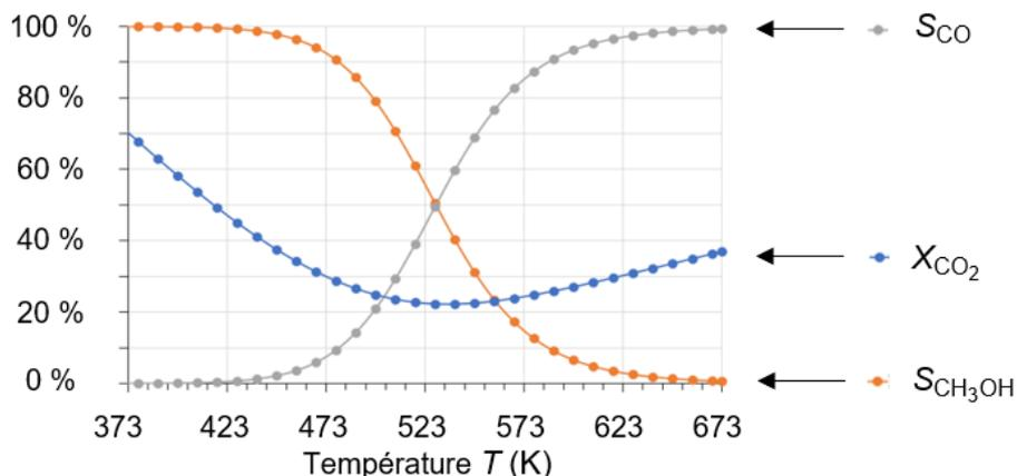
**Figure 3** - Influence de la température  $T$  sur le taux de conversion du dioxyde de carbone  $X_{\text{CO}_2}$  et les sélectivités  $S$  en méthanol  $S_{\text{CH}_3\text{OH}}$  et en monoxyde de carbone  $S_{\text{CO}}$ , à l'état d'équilibre, pour les réactions impliquées dans l'hydrogénation de  $\text{CO}_2$ <sup>2</sup>
